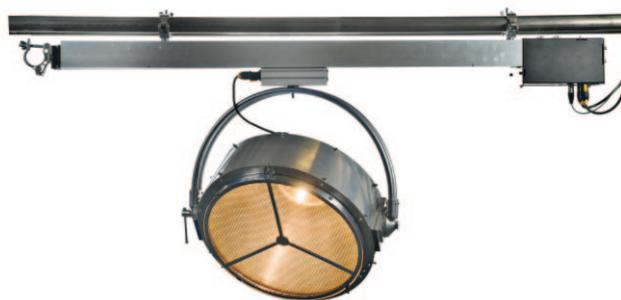
à fumée, des éléments de décors. Ce rail motorisé, est proposé dans 5 modèles avec des courses allant de 1,50 m à 5,50 m, supportant tous des charges verticales ou horizontales en déport de 20 kg ou des charges horizontales suspendues de 50 kg.
